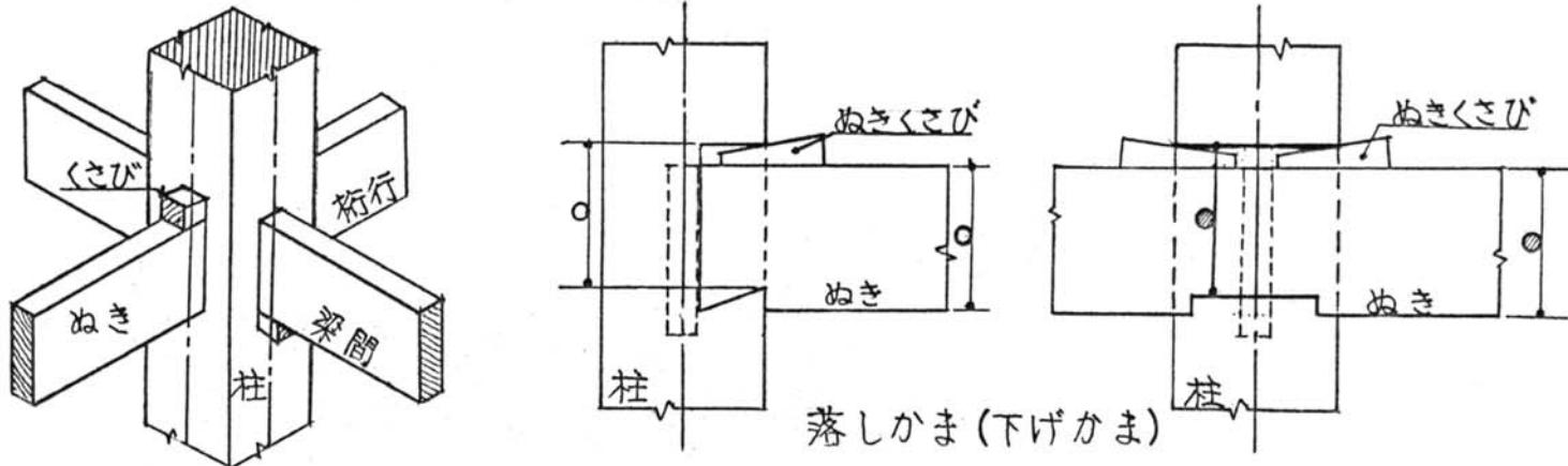
壁貫の大きさ(寸法)について。柱(壁厚)の大きさよって貫の大きさが異なる。最近は柱の大きさが135~120mm(4.5~4.0寸)角が主流で、壁貫の大きさは180~150mm(6~5分)×120~105mm(4.0~3.5寸)が使用されている。貫穴は貫材より3mm(1分)位大きく、楔代(くさびしろ)1.8~1.5mm(6~7分)(楔の締る余地)大きく膨る。
